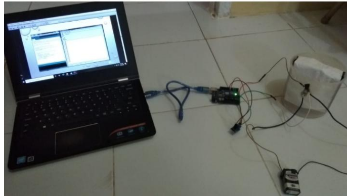
Gambar 3. Alat percobaan berbasis Arduino untuk mendeteksi Tsunami
