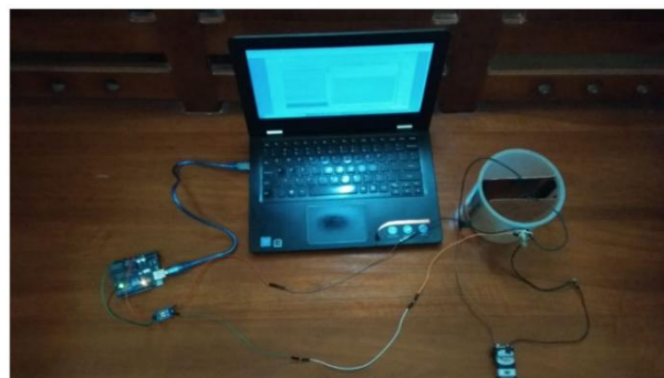
Gambar 4 Alat percobaan berbasis Arduino untuk penjernih air dengan metode elektrolisis
