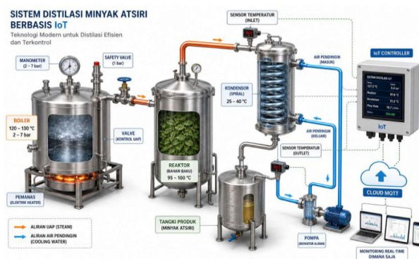
Gambar 5 Alur Kerja Teknologi Arroma Smart Distiller
