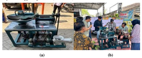
Gambar 6 (a) Mesin Penggiling Adonan Bakso, (b) Demo Penggunaan Mesin Pengaduk Adonan
