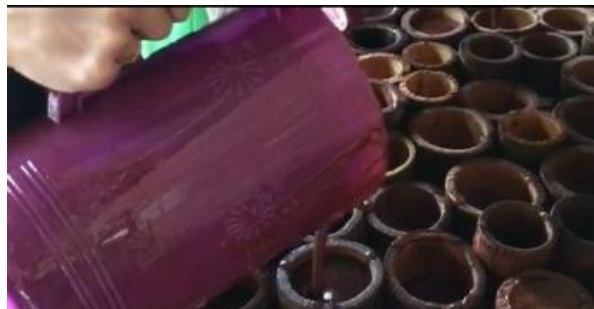
Gambar 10 Pencetakan Gula Merah menggunakan Bambu
