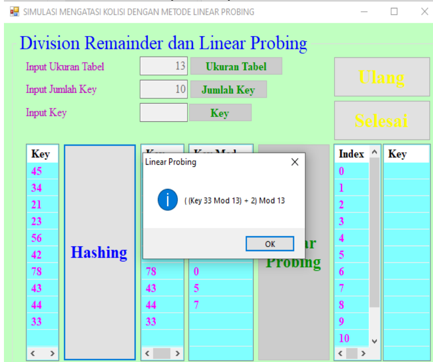
Gambar 13. Linear Probing Key 33 dengan i=2
